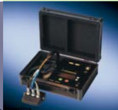
MAG 6000 limpieza de los electrodos
